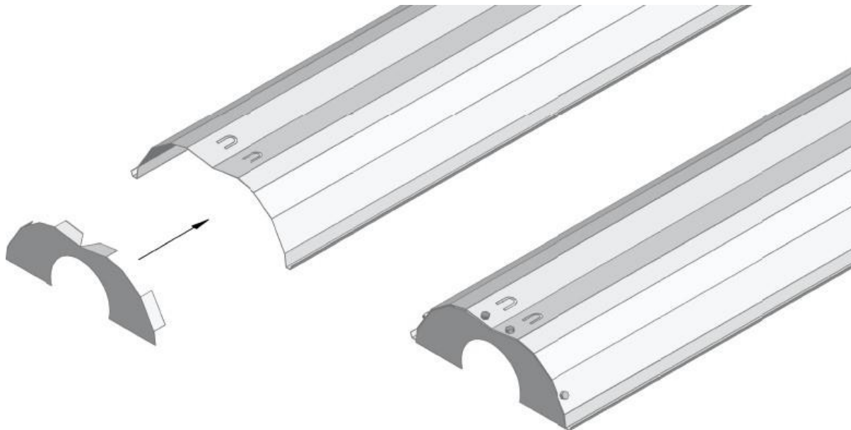
9. obrázok: Montáž koncového dielu
