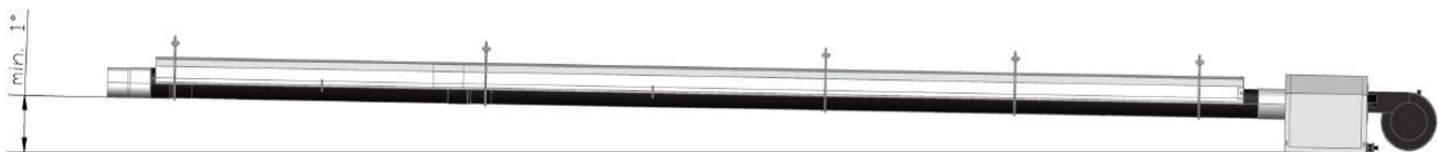
18. obrázok Minimálny sklon pri inštalácii
