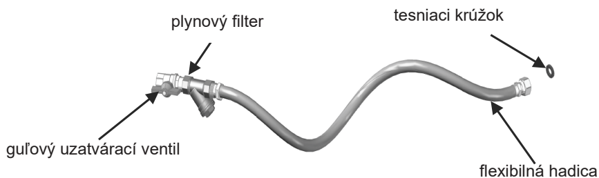
5. obrázok: Pripojenie s flexibilnou sadou
