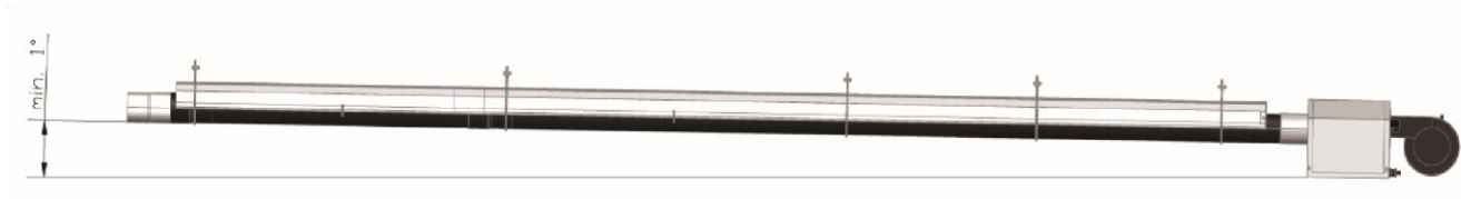
Рис. 25: Минимальный угол наклона при монтаже
