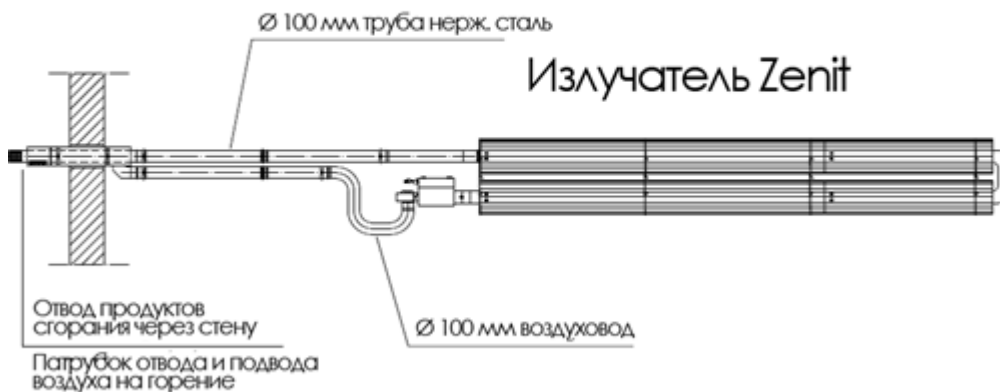
Рис.35: Коаксиальный отвод продуктов сгорания через стену
