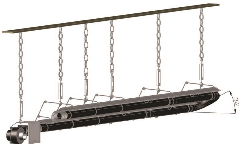
Рис.26: Максимально допустимый угол наклона
