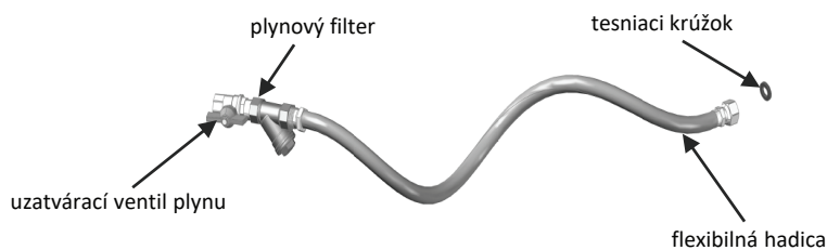
11. obrázok: Pripojenie pomocou ohybnej hadice
