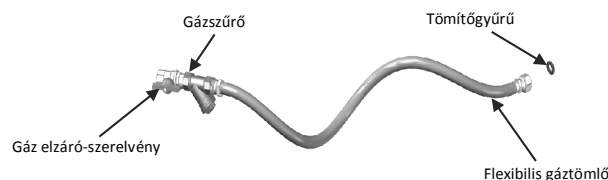
4. ábra: Csatlakoztatás flexibilis tömlővel (opció, a készülék gyártónál megvásárolható)
