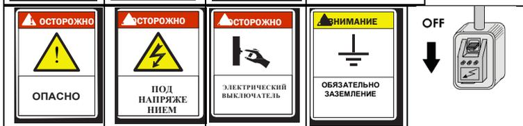
Рекомендуем недалеко от воздухонагревателя установить электрический выключатель, для удобства отключения электропитания. Перед ремонтными или сервисными работами всегда отключайте электропитание.
